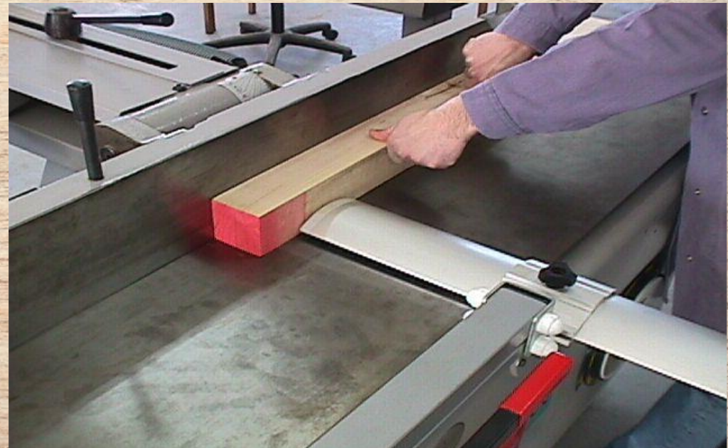
Πλάνισμα της δεύτερης επιφάνειας του ξύλου με ταυτόχρονο γώνιασμα (γωνιά)
