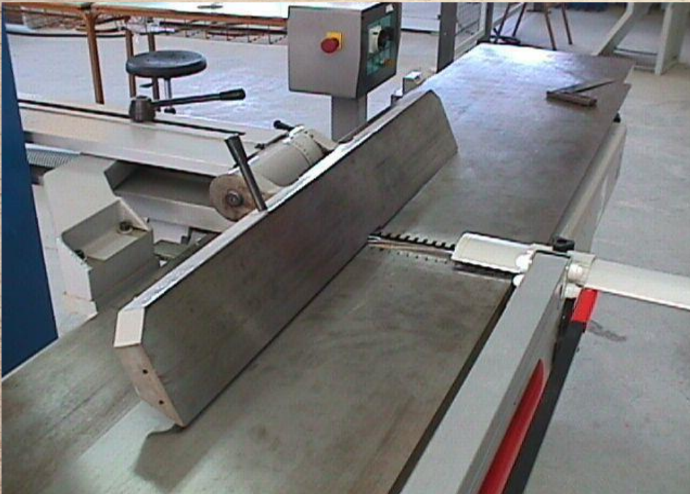
Οδηγός με κλίση σε πλάνη για λοξά πλανίσματα
