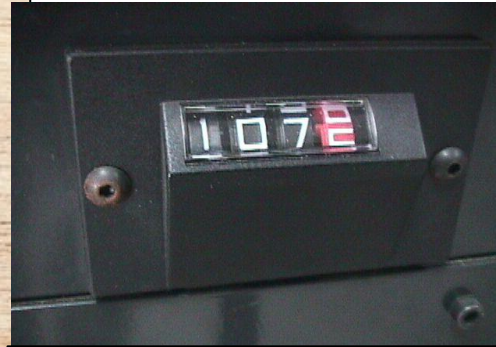
Δείκτης ένδειξης του τελικού πάχους του ξυλοτεμαχίου
