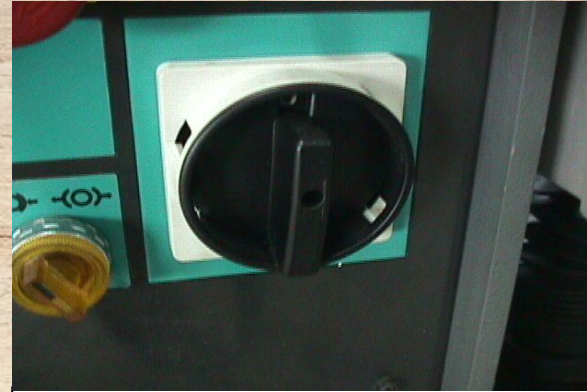
Διακόπτης παροχής ρεύματος ξεχονδριστήρα
