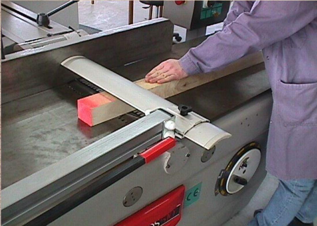
Πλάνισμα της μιας επιφάνειας του ξύλου (πλανιά)
