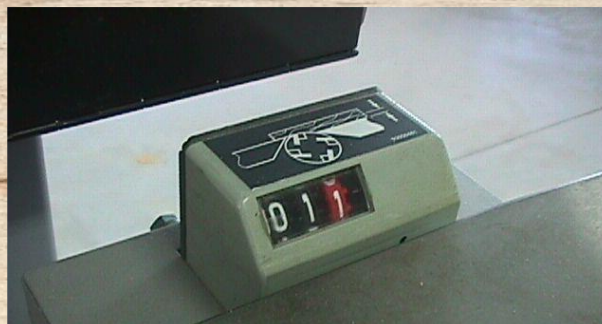
Δείκτης ένδειξης του βάθους κατεργασίας στην πλάνη
