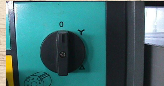
Διακόπτης εκκίνησης του ξεχονδριστήρα
